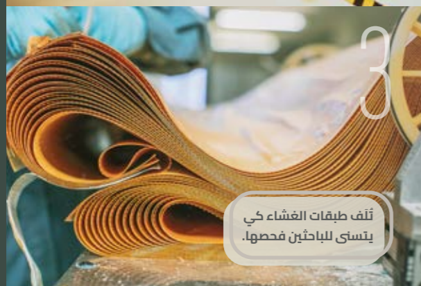
تُخذ المياه التي سيجري تحليلها عبر أغشية موضوعة داخل أوعية ضغط.
